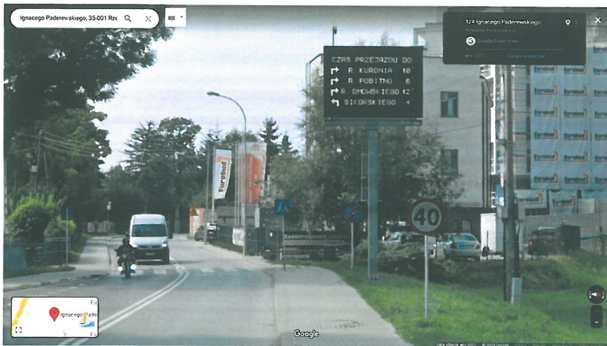
Rysunek 3. Kolejny ekran który może rozpraszać uwagę kierowców nad przejściem dla pieszych. Treści na nim prezentowane nie mają najmniejszego sensu dla kierowcy, lepiej wyświetlać czas ewentualnego opóźnienia np. +5min w stosunku do normalnej jazdy żeby kierowca mógł szybko sobie oszacować, o ile się spóźni, albo która droga będzie lepsza. W przypadku braku zatorów komunikacyjnych tablica dla oszczędzania energii mogłaby być wyłączana.
